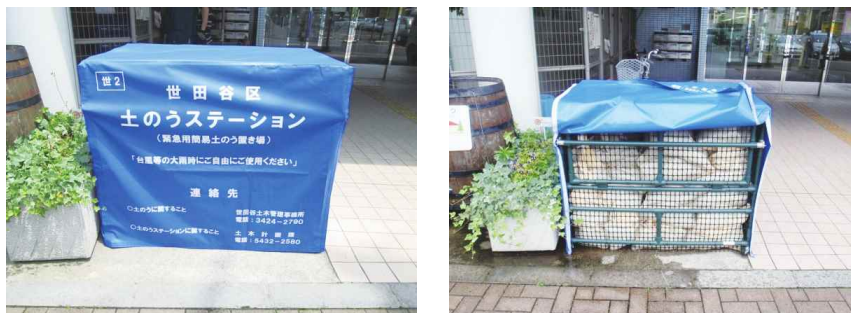
写真 7-1 土のうステーションの例（世田谷区）
