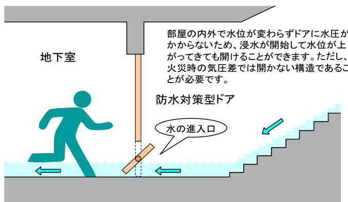
図 28 水圧で閉鎖されないドアの設置
