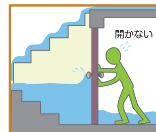
水圧でドアが開かない
